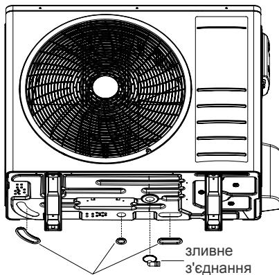
1. Під'єднайте зовнішнє зливне з'єднання до отвору на шасі, як показано на рисунку нижче.
