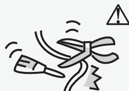
Не тягніть, не тисніть на кабель джерела струму, пошкодження кабелю спричинить ураження струмом чи пожежу.
